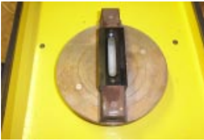
Установка и выверка гончарного круга по уровню
