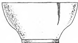
Рис. 45. Трещина, образовавшаяся при сушке, расширяется снизу вверх
