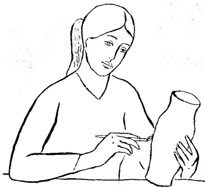
Рис. 83 Положение рук при росписи. Правую руку кладут на стол, а в левую берут изделие и прижимают его к столу
