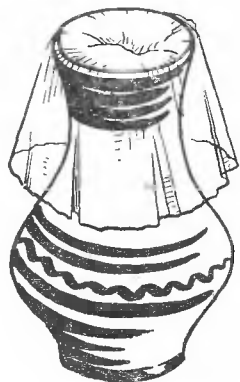
Рис. 44. Замедление сушки при помощи полиэтилена или фольги
