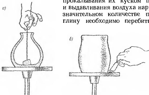
Рис 23. Удаление избытка влаги и жидкой массы
