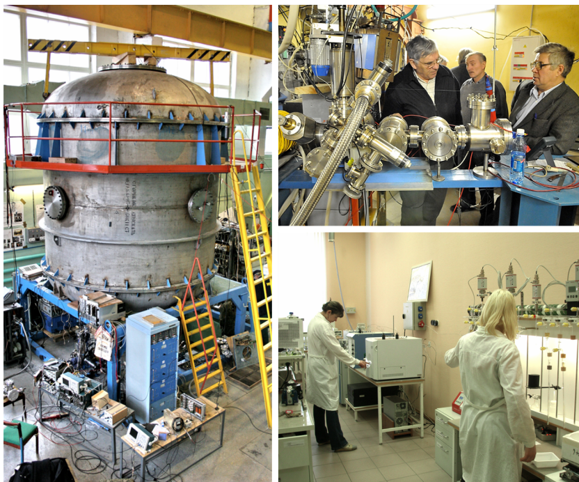
Рис. 26. Ускорительный масс-спектрометр (УМС) и лаборатория для подготовки образцов для УМС в Центре коллективного пользования «Геохронология кайнозоя» СО РАН (фото с сайта ИАЭТ СО РАН http://www.archaeology.nsc.ru )
