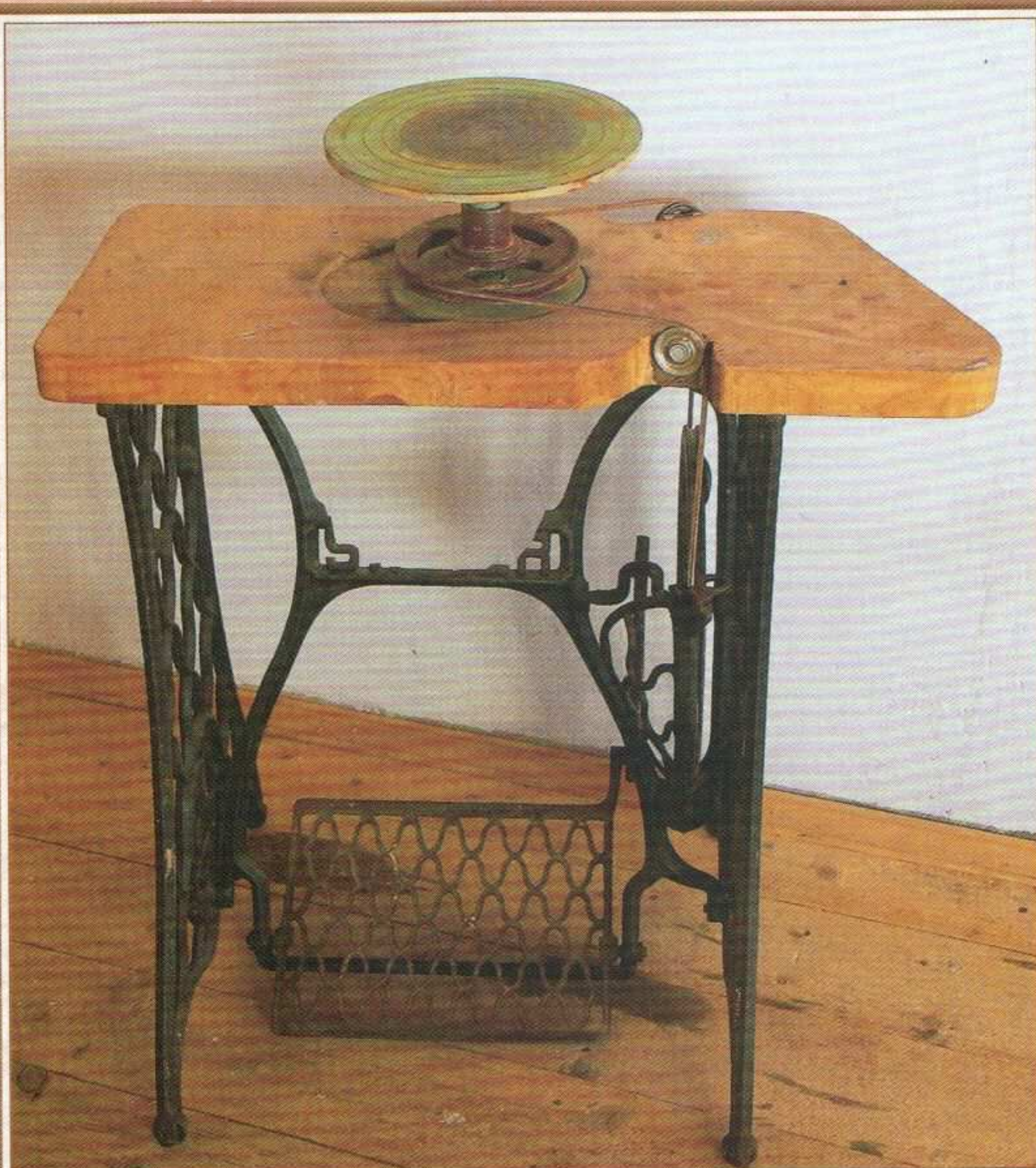
Гончарный круг на базе станины швейной машинки «Зингер»
